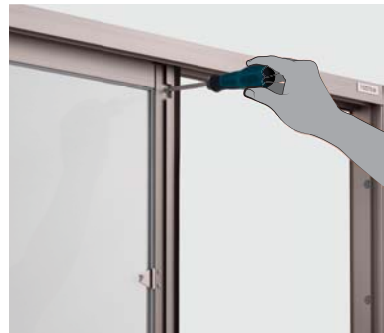
Easily adjustable outer-panel lock ตัวล็อกบาน ป้องกันการงัดเปิดบานจากฝั่งนอกบ้าน
